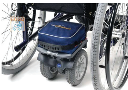
Obrázek 37: Pohon typu Power Pack pro méně náročné uživatele
